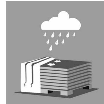
Gestapeltes Material bauseitig mit Bauplane gegen Feuchtigkeit und Verschmutzung schützen. Die Bauplane muss bei gestapeltem Material aufgelegt bleiben. Stehende Feuchtigkeit zwischen gelagerten Tafeln kann zu Kalkausblühungen führen, die nicht mehr entfernt werden können und die Qualität der Sichtfläche dauerhaft schädigen.
