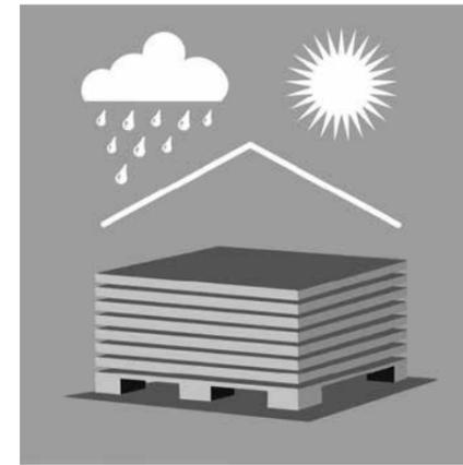
Fassadentafeln aus Faserzement sind auf einer ebenen Unterlage trocken und vollflächig zu lagern. Die zwischengelegte Schaumstoffolie dient zum Schutz der hochwertigen Oberfläche und ist bei Umstapelungen stets wieder einzu-
