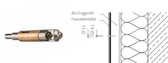
Durch die  $\varnothing 11$  mm vorgebohrten Fassadentafeln werden zentrische Bohrungen  $\varnothing 4,1$  mm in das Tragprofil mit der Bohrlehre 11/4,1 erzielt.
