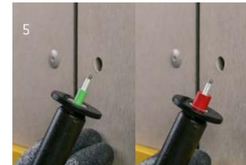
Gleitpunkte werden mit dem Universal-Niet ausgebildet (links), für Festpunkte wird zusätzlich auf die grüne Hülse die rote Festpunkthülse 08 gesteckt (rechts).
