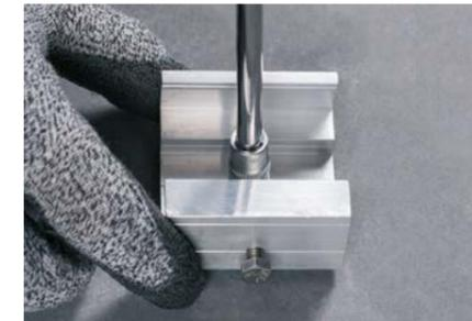
Die Zahnmutter ist mit einem Akku-Schrauber mit Drehmoment ( $T_{inst} \sim 5Nm$ ) zu fixieren. Es wird empfohlen mit einem niedrigen Drehmoment zu beginnen und diesen bei Bedarf zu erhöhen. Die Agraffe soll gegen Mitdrehen gesichert werden.
