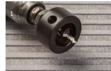
Fassadentafel liegend vorbohren, ggf. Bohrschablone verwenden. Empfohlener Bohrer: Bohr- und Fräswerkzeug [linea].
